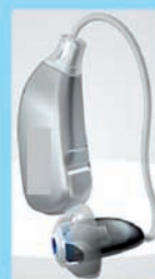
Digitales Hinter-dem-Ohr-Hörgerät mit Trennung von Mikrophon und Hörer, das eine «offene» Anpassung erlaubt
